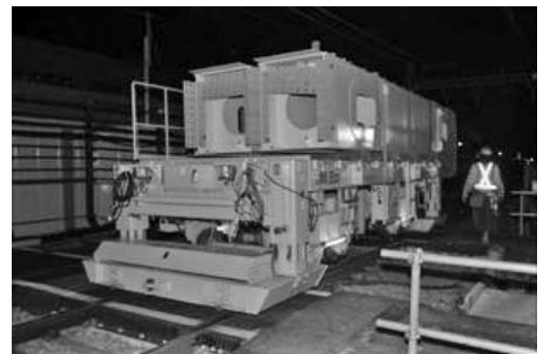
写真一五 軌陸式重量物運搬台車
