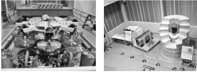
写真-9 真空把持装置と人工バリア模型
