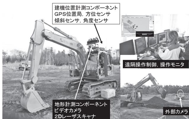
写真1 検証実験に必要な機器構成
