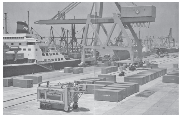
写真-12 初期のコンテナヤードで活躍するコンテナキャリア
