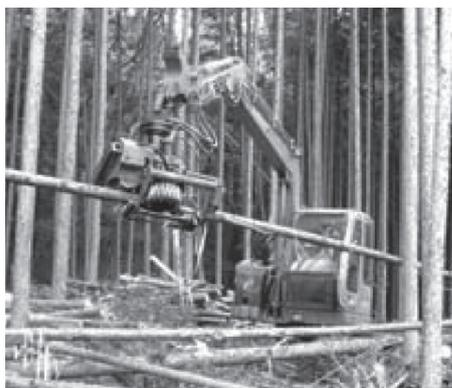
写真—1 高性能林業機械（プロセッサ）
