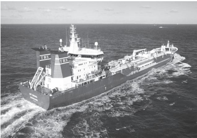
写真一1 2012年にLNGと船用重油の2元燃料化への改造が発表された石油製品タンカー「Vit Viking」(25,000総トン)
