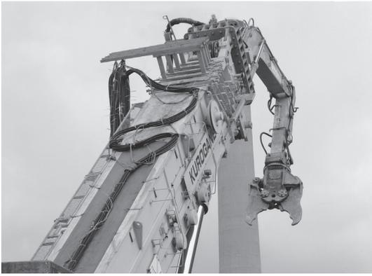
写真—10 油圧破碎機
