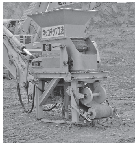
写真-3 高速ベルトコンベア搭載撒きだし装置
