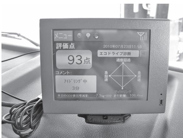
写真-1 ECO-DAS 車載端末
