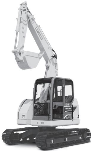
写真-2 加藤製作所 HD308USV 油圧ショベル (後方超小旋回形)
