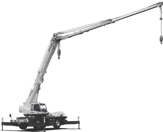
写真—5 加藤製作所 R250R PREMIUM ラフテレーンクレーン (伸縮ブーム形)
