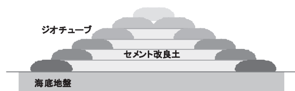
図—2 ジオバンド断面形状図
