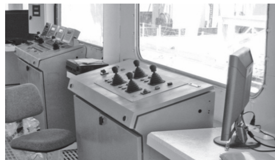
写真—7 操船ウインチ操作卓
