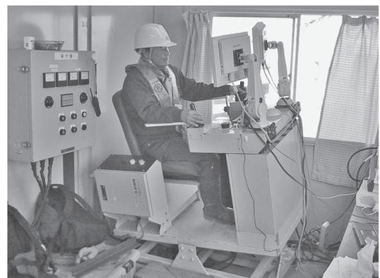
写真-4 遠隔操縦状況（体感装置）
