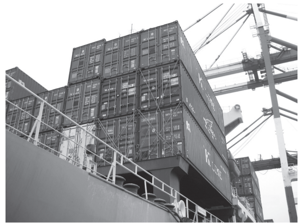
写真-5 ラッシングパイプによる固縛（2段目まで）
