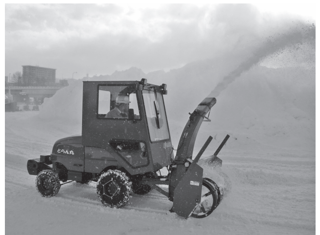
写真一七 小型作業車にロータリー装置を付けた「とらん丸」の除雪
