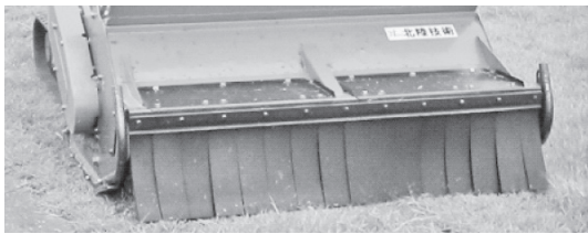
写真一2 飛石防止装置
