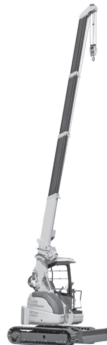
写真—4 (株)前田製作所 LC383M-5 クローラクレーン ブーム伸長時
