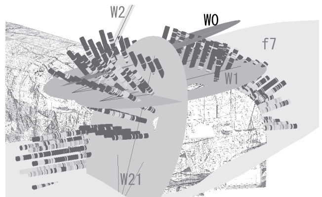
図一十 穿孔検層結果（空洞縦断方向）：巻頭グラビア参照
