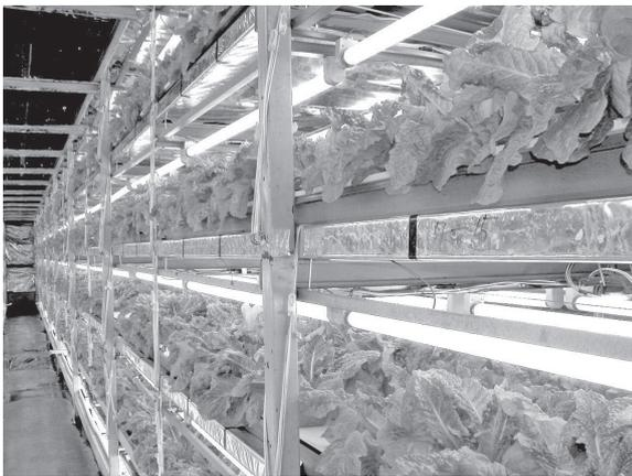
写真—1 蛍光灯による棚段式完全制御型植物工場
