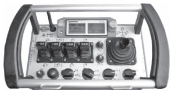
写真一二 リモコンによるブーム制御操作
