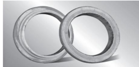
写真一九 切替プレートとカッティング・リング
