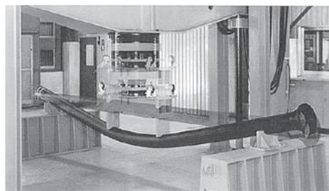
写真-1 管体曲げ試験
