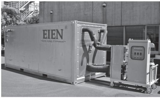
写真一 炭酸化養生槽
