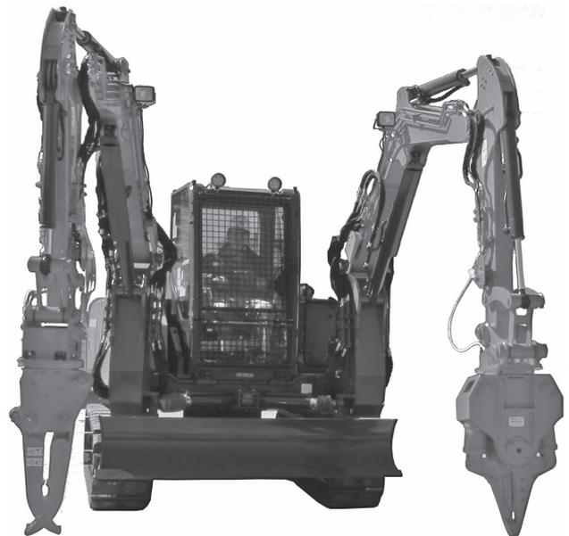
写真一 1 日立建機 ZX70TF-3 [ASTACO] 双腕作業機
