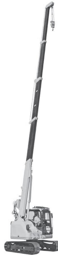
写真-5 前田製作所 LC785M-8 クローラクレーン ブーム伸長時
