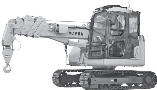
写真-4 前田製作所 LC785M-8 クローラクレーン 走行姿勢
