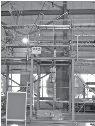
写真一 1 手すり枠落下阻止性能試験
