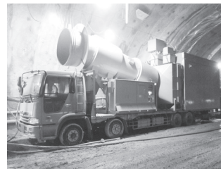
写真—7 電気式集塵機2,400 m 3 /min
