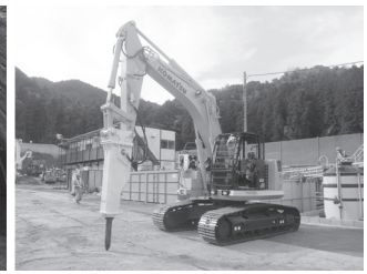
写真—2 大型ブレーカ1,300 kg級
