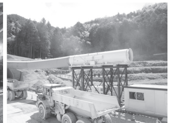
写真—8 コントラファン2,000 m 3 /min
