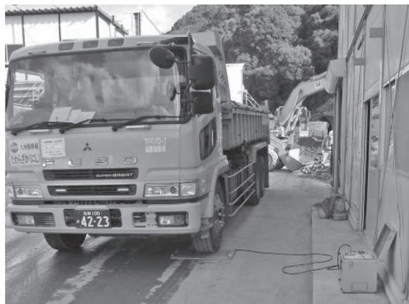
写真—6 ポータブル型車両重量計
