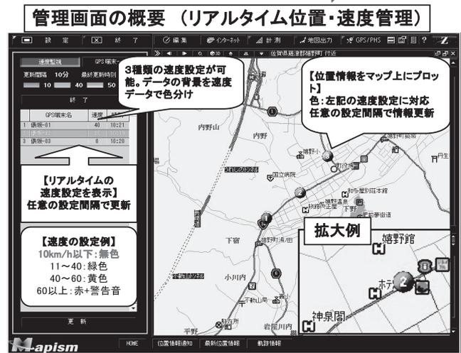
図-7 GPS車両位置管理システム
