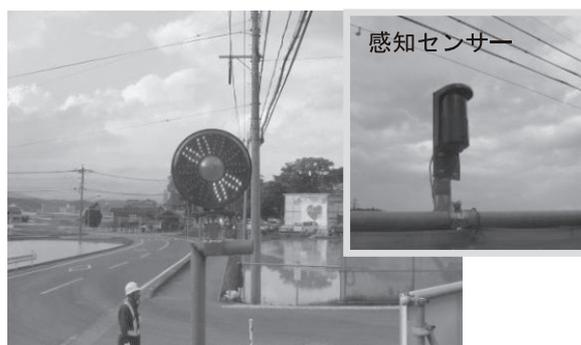
写真—5 車両感知センサー
