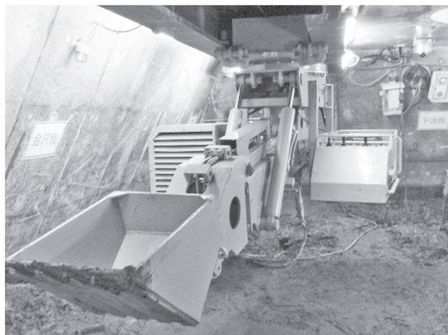
写真一8 天井走行型無人掘削機
