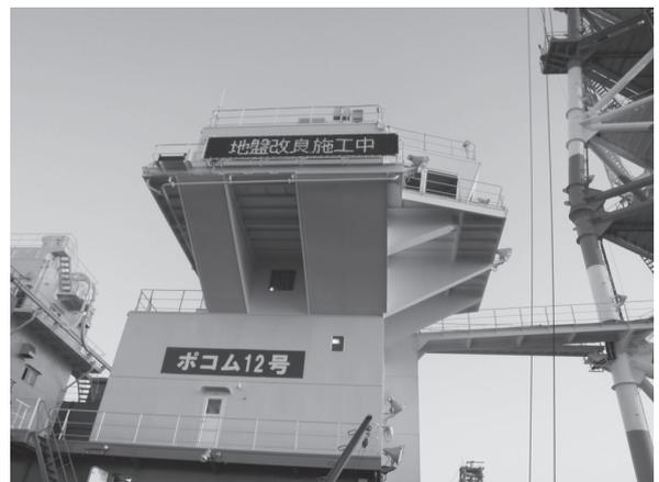
写真—13 電光掲示板と全方位視野確保型操作室
