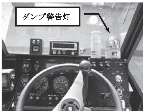
写真-9 ダンプ警告灯
