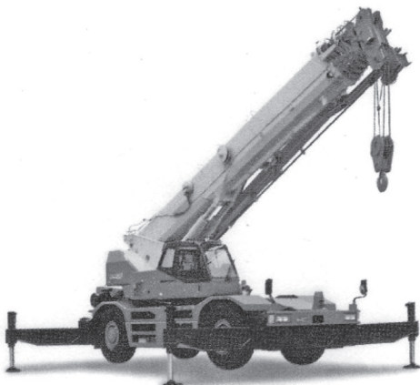
写真-1 ラフテレーンクレーン
