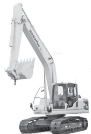
写真-3 クレーン機能を備えたドラグ・ショベル
