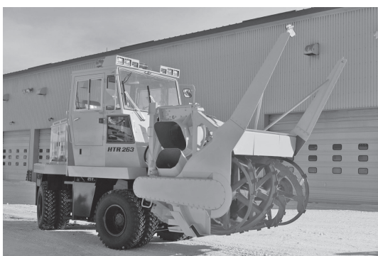
写真-3 車体屈折式ステアリング
