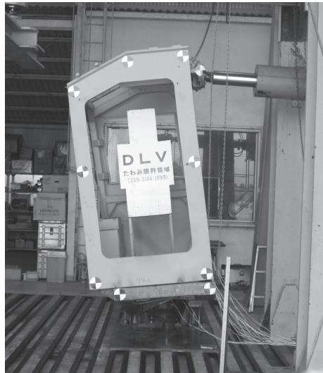
写真-4 ROPS 試験状況
