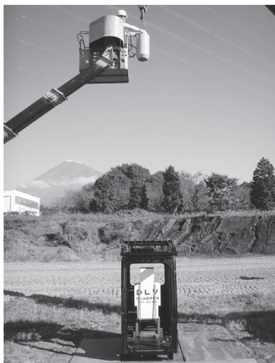
写真一3 トップガードの試験状況
