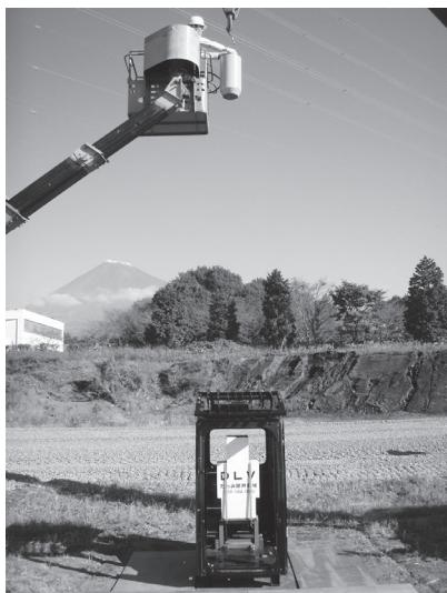
写真-3 トップガードの試験状況
