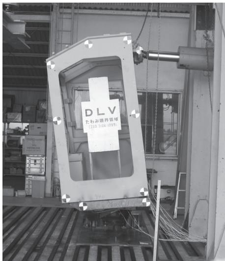
写真一 4 ROPS 試験状況
