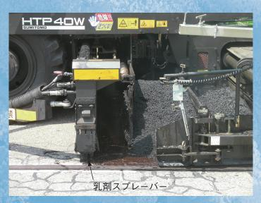
小型乳剤散布装置付きアスファルトフィニッシャの施工状況
