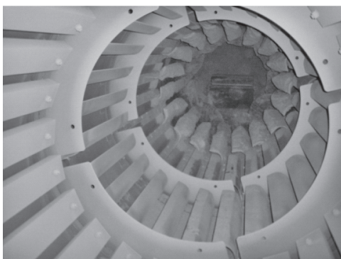
写真—4 回転数制御ドライヤ内部
