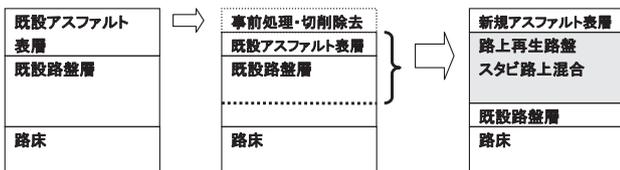
図—2 事前処理(切削)を行って安定処理する方法の適用例
