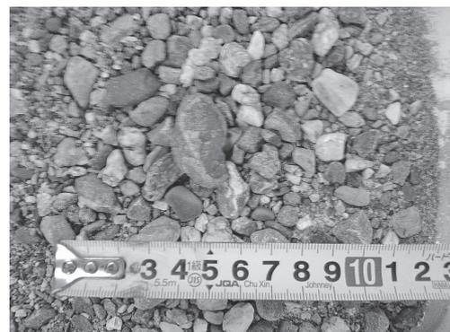
写真—4 採取試料（二重管式施工）
