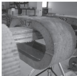
写真-12 着色水浸透試験結果
