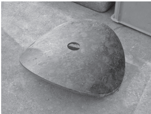
写真一八 切り取った既設管
