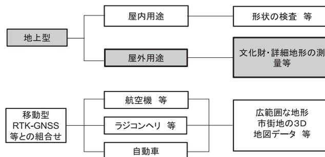
図1 レーザー scanner の主な利用形態
