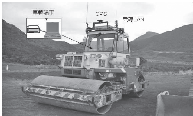
図-10 転圧ローラー
