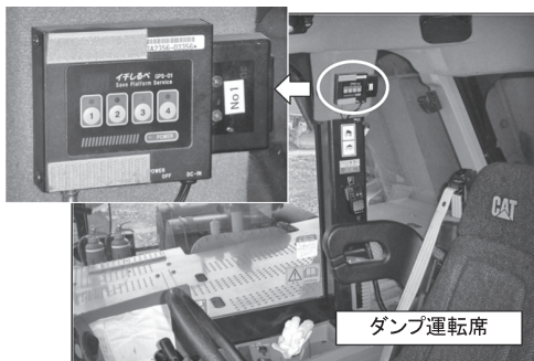
写真一2 盛立材料識別システム GPS 端末 (イチしるべ)
