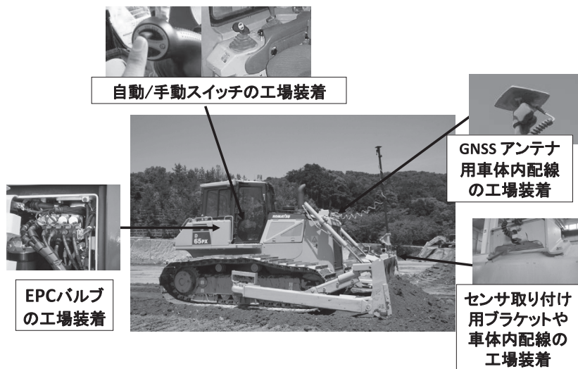
図-9 プラグアンドプレイ対応建機の例
