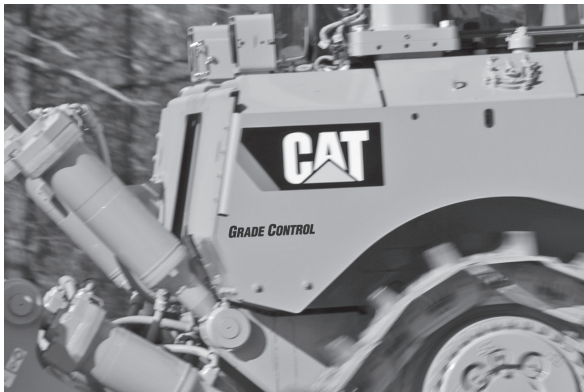
写真—1 新作業装置自動制御システムを搭載したブルドーザ
