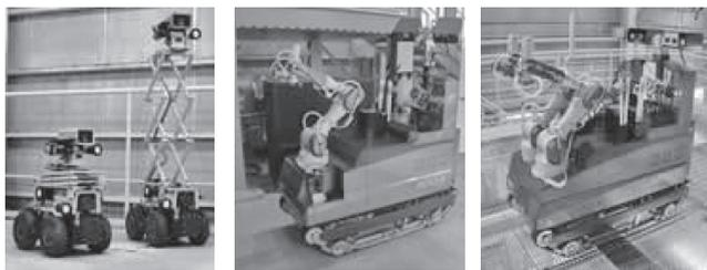
写真一五 RESQ-A 初期情報収集 写真一六 RESQ-B 詳細情報収集 写真一七 RESQ-C 試料等情報収集
