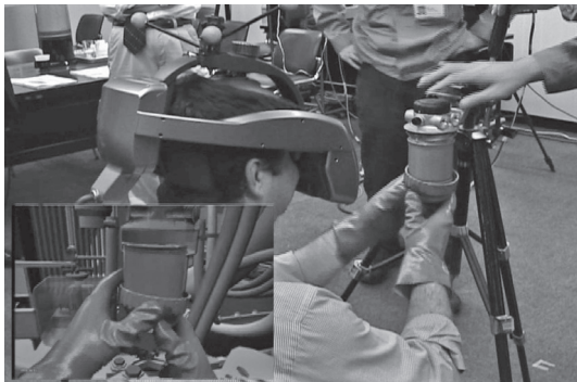
写真-3 フィルタ交換のしやすさのチェック
