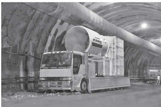
写真-1 稼動中の高効率電気集じん器
