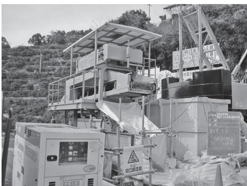
写真-11 泥水処理設備
