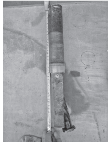
写真—1 孔内溝切装置
