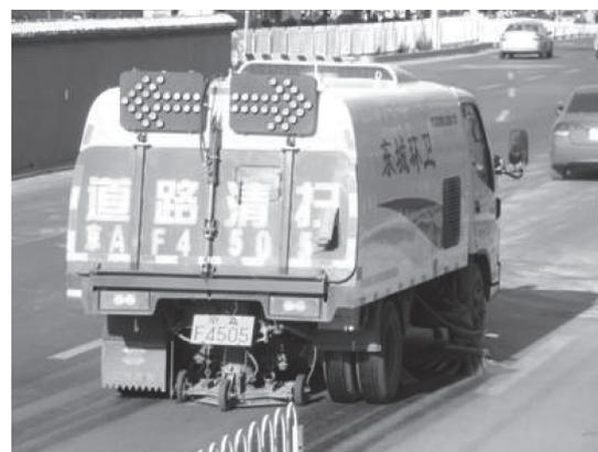
写真—8 稼働中の路面清掃車（中国製）
