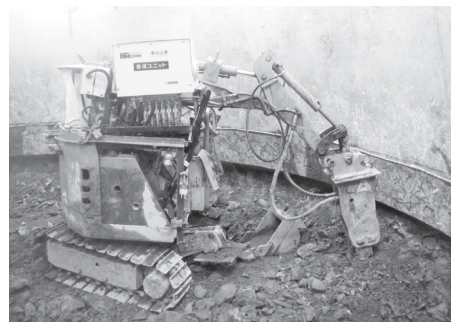
写真1 地上走行式の無線型遠隔操作掘削機
