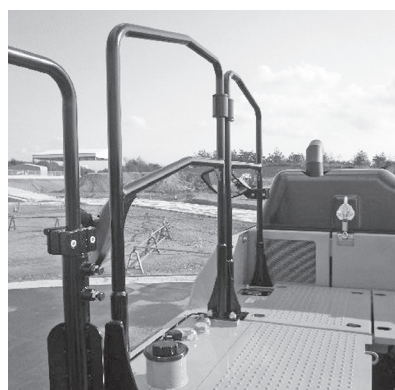
写真一 7 大型ガードレール
