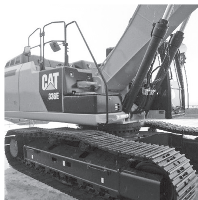
写真一 6 大型ハンドレール&amp;ステップ
